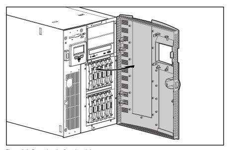
Figure 2-3. Removing the front bezel door
